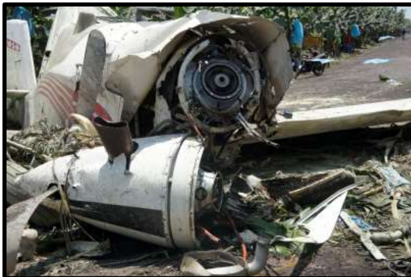
Fotografía No.: 6 Vista del motor y los daños.
