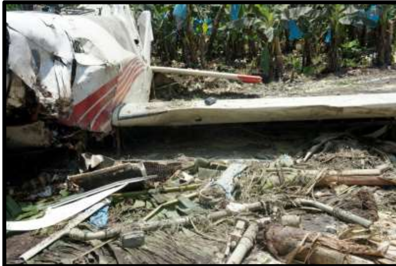
Fotografía No.: 9 Daños estructurales del ala izquierda.
